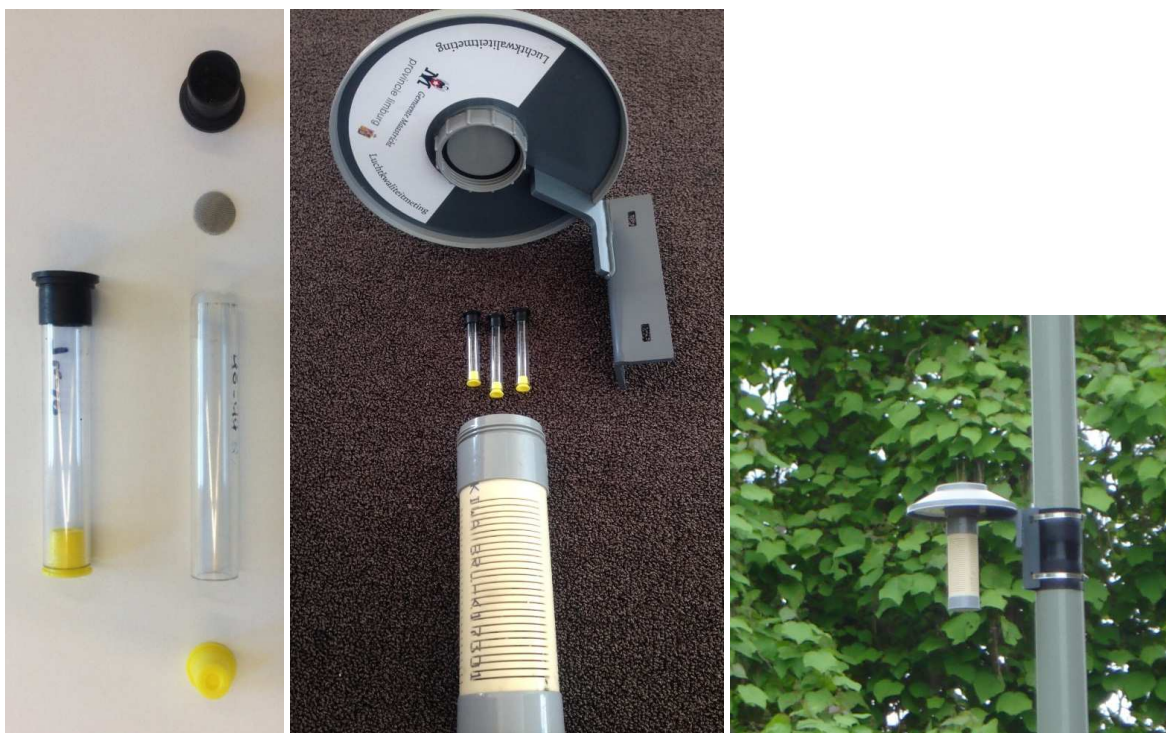
Figuur 6: Diffusiebuisjes en houder zoals gebruikt voor het onderzoek van 2013-2014: Diffusiebuisje, gesloten en open, (tijdens gebruik wordt alleen het gele dopje verwijderd); de diffusiebuisjes en de open houder; en de houder aan een lantaarnpaal.
